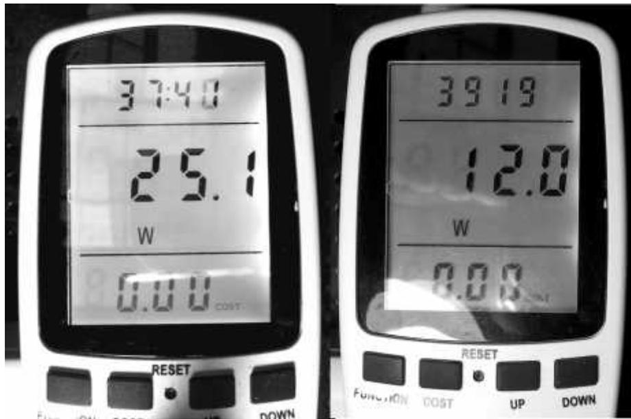
**Figura 4:** La foto de la izquierda muestra la potencia máxima del motor registrada por el vatímetro (TRUE RMS). Con  $0.88$  (Amperios RMS) \*  $220$  (Voltios RMS) \*  $0.13$  (coseno de  $\phi$ ) =  $25.1$  (Watts), potencia activa en vatios. Girando a 3000 (RPM), velocidad de sincronicidad de la corriente alterna (AC).
